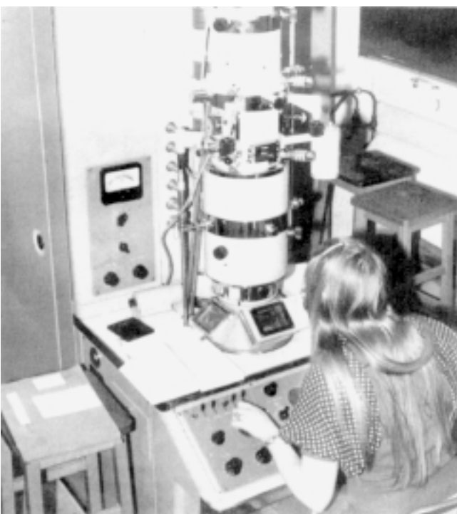
El microscopio electrónico de transmisión, utilizado en una amplia variedad de campos de investigación, es una de las herramientas de trabajo de la investigación experimental.
